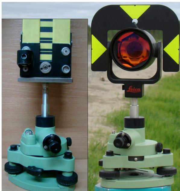
Рис. 1. Схема постановки нивелирной рейки на адаптер
