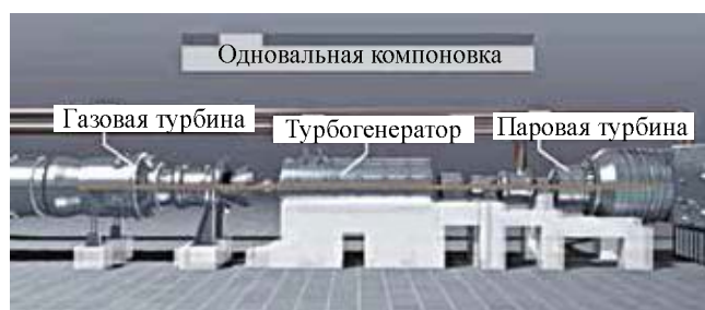
Рис. 4. Схема одновальной компоновки оборудования
