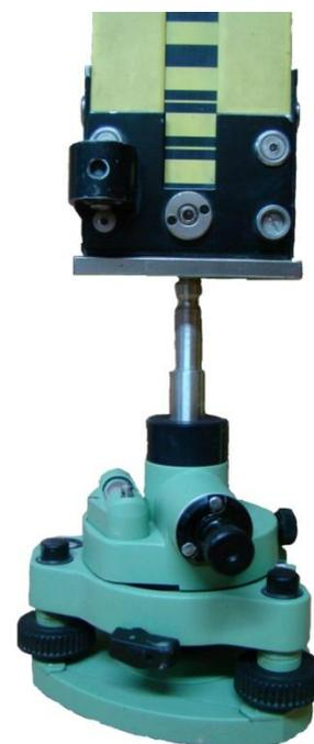
Рис. 1. Постановка рейки на адаптер
